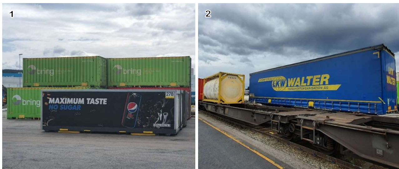
Figur 4-16: Typiske lastbærere som løftes som transporteres til- og fra Alnabruterminalen. Bilde 1 viser 20-foter kontainer bakerst og flak fremst. Bilde 2 viser tank med våtbulk t.v. og kontainer til semi-henger (1,7 TEU) t.h.
