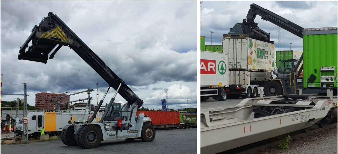
Figur 4-17: Reach stacker og utført løft fra lastebil til vogn (slerke). Foto: Norconsult AS
